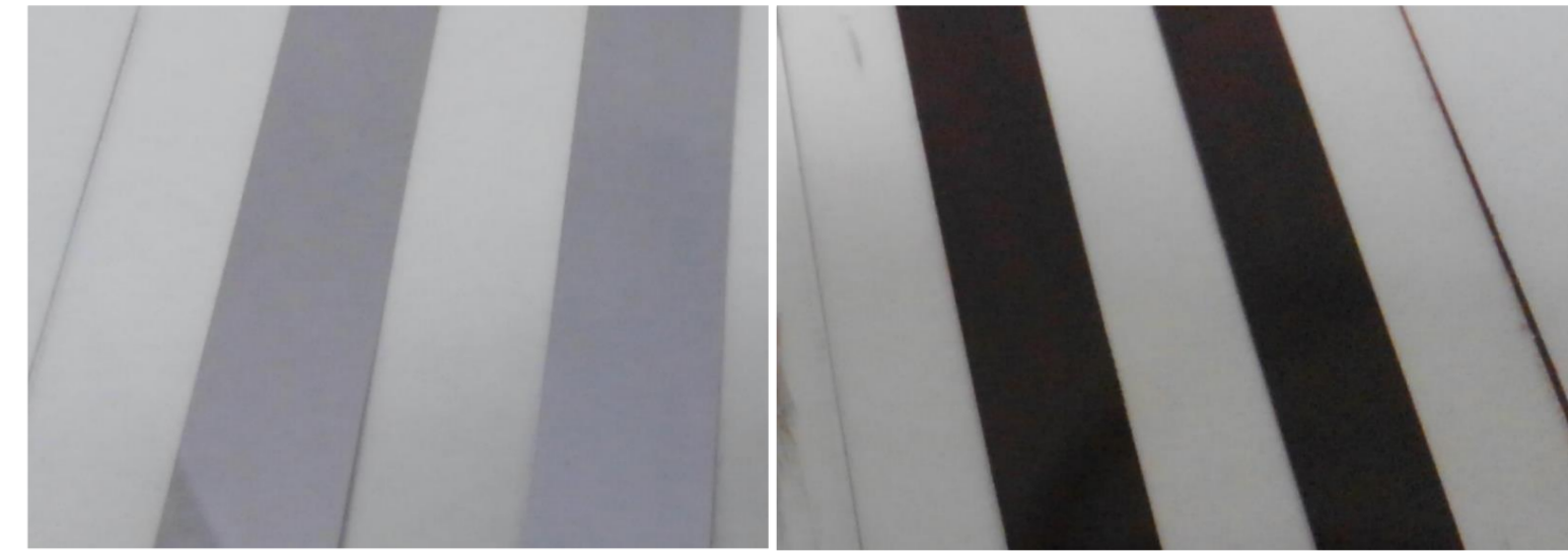
ガラス裏面からの観察例 Ti/Cuスパッタ膜
